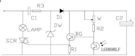
上图为光控路灯电路,白天路灯熄灭,夜路灯自动点亮。图中,电容 CI、C2、R3 和二极管 D1 及稳压管 DW,组成简单的电容降压整流电路,接通电源后获得 12V 左右的直流电压。三极管 BG、环境光探测器 LG0898LF 和双向可控硅等,组成光电开关电路。
